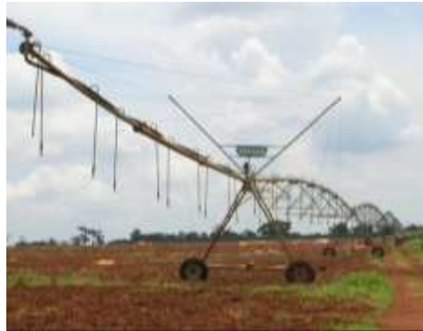
Figura 87: Lance final do pivô em balanço com canhão final.
