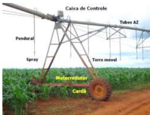
Figura 84: Exemplo de torre móvel de pivô central, com destaque para as suas partes constituintes e o sistema de movimentação das rodas.
