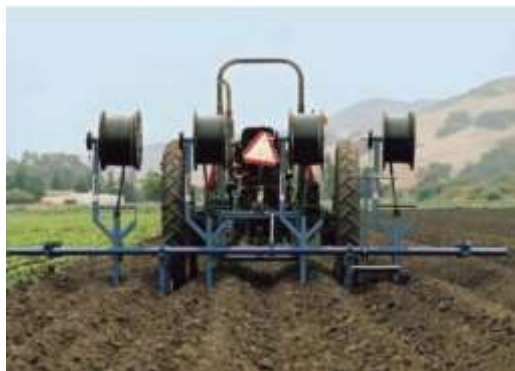
Figura 183: Detalhe de implemento utilizado para instalação de linhas laterais subsuperficiais (Fonte: KIZER, 2011).
