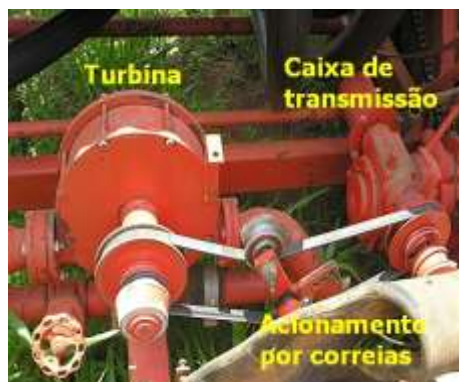
Figura 105: Detalhes do sistema de acionamento de um autopropelido.
