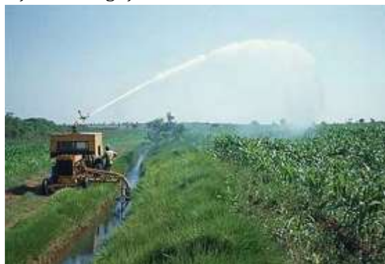
Figura 115: Detalhe da utilização de um sistema de montagem direta na cultura do milho.
