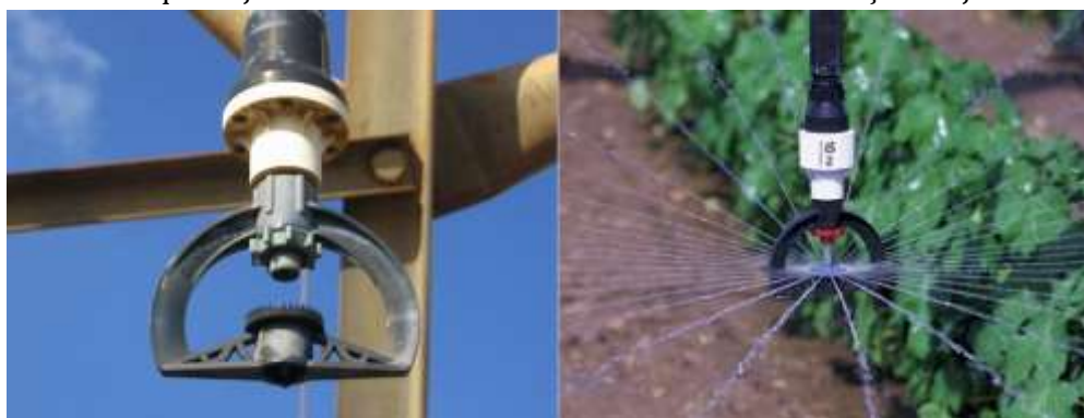
Figura 59: Exemplo de um spray utilizado em pivô central, classificado como fixo ou estacionário.
