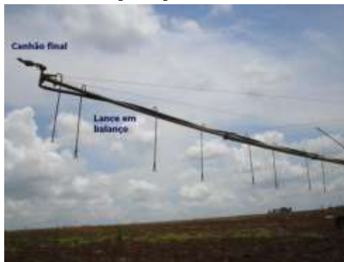
Figura 88: Detalhe de um canhão final no lance em balanço do pivô.
