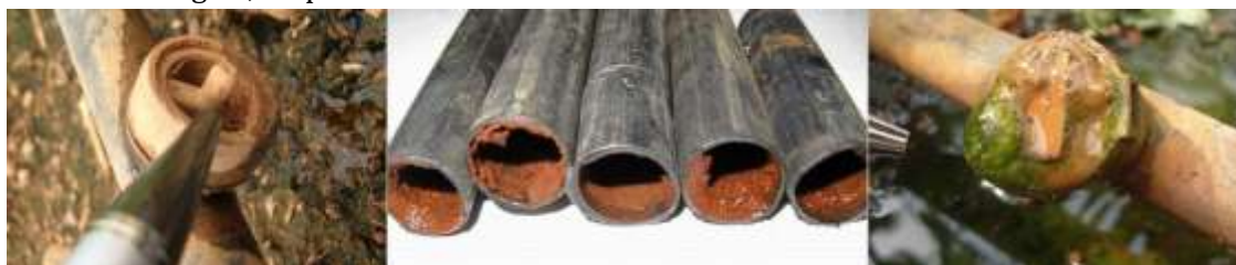
Figura 155: Tipos de entupimentos em irrigação localizada: físico (esquerda), químico (centro) e biológico (direita).
