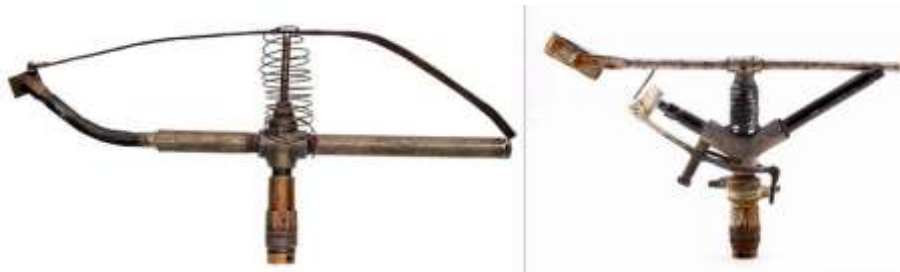
Figura 49: Detalhes de dois estágios de desenvolvimento do primeiro aspersor rotativo fabricado pela empresa Rainbird em 1935. (Fonte: IRRIGATION MUSEUM, 2010b).
