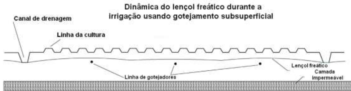
Figura 190: Ilustração esquemática da operação da irrigação por gotejamento subsuperficial na elevação do lençol freático durante a irrigação da área (Fonte: Adaptação de ZOTARELLI et al., 2013).
