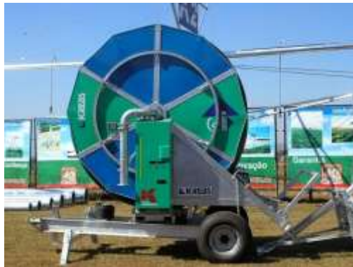
Figura 114: Exemplo de carretel utilizado em sistemas autopropelidos com movimentação por mangueiras.
