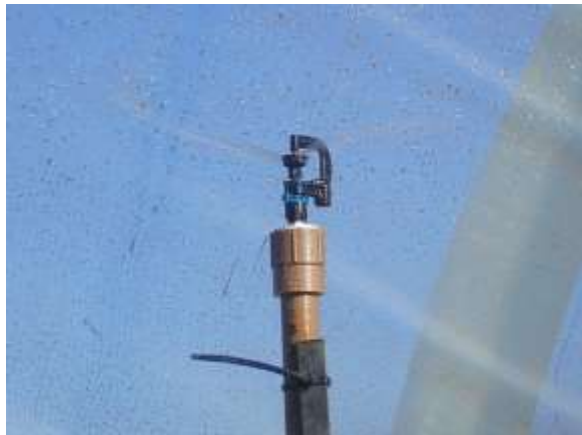
Figura 159: Detalhes de um microaspersor rotativo com o sistema de dispersão do jato (Fonte: ANTUNES, 2006).
