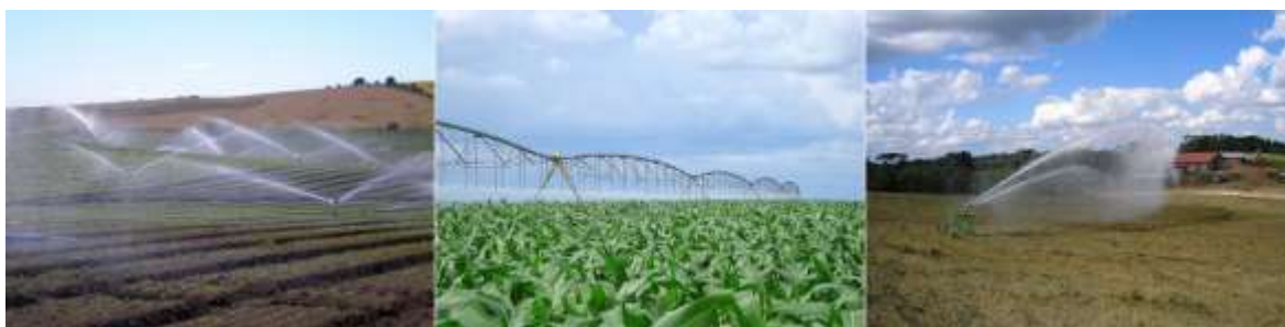
Figura 9: Sistemas de irrigação por aspersão: sistema convencional com movimentação manual (esquerda), sistema por pivô central (centro) e a carretel enrolador (direita).
