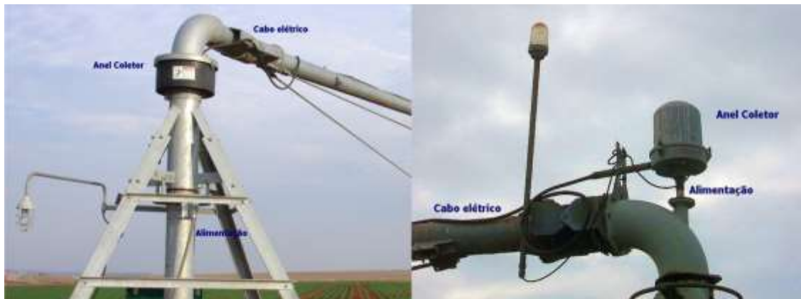
Figura 82: Dois modelos de anel coletor utilizados em pivô: cabo externo à tubulação (esquerda) e interno (direita) (Fonte: LINDSAY, 2010 e VALMONT, 2010).
