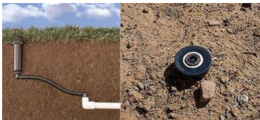
Figura 229: Detalhe da instalação de um aspersor escamoteável abaixo do nível da vegetação.
