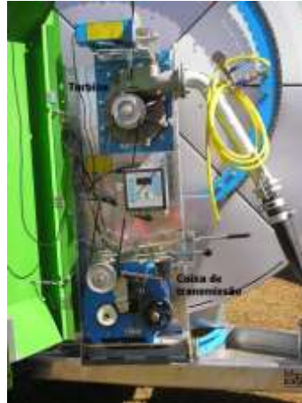
Figura 113: Detalhes de um sistema de movimentação automatização de carretel enrolador (Fonte: BAUER, 2010).
