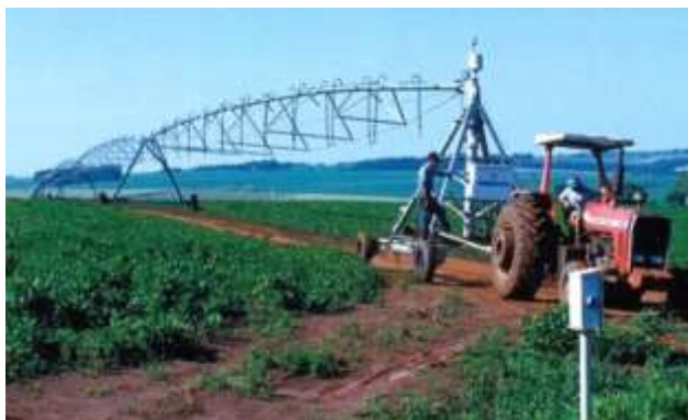
Figura 96: Detalhe de um pivô rebocável sendo transportado entre áreas irrigadas. (Fonte: FOCKINK, 2010)
