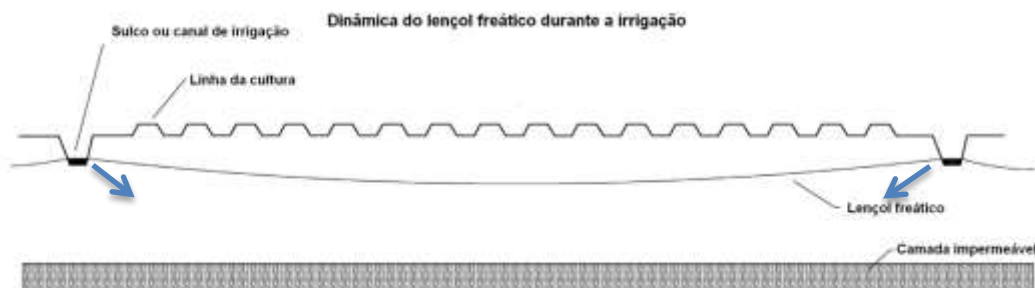
Figura 186: Ilustração esquemática da contribuição do canal de irrigação para o lençol freático (Fonte: Adaptação de ZOTARELLI et al., 2013)
