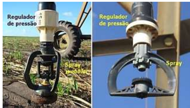
Figura 95: Exemplo de emprego de reguladores de pressão em emissores de pivô central.
