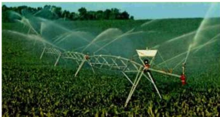
Figura 89: Pivô central operando com aspersores rotativos de impacto instalados na parte de cima da tubulação principal.
